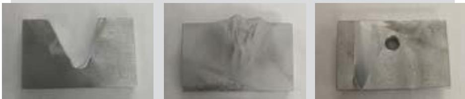
图4 模拟维修试样(a) 喷涂前; (b) 喷涂后; (c) 机加工后
