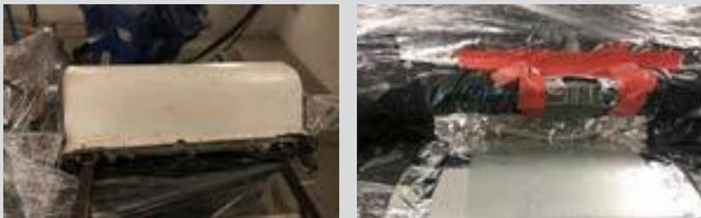
图5 冷喷涂前对下曲轴箱进行屏蔽处理
